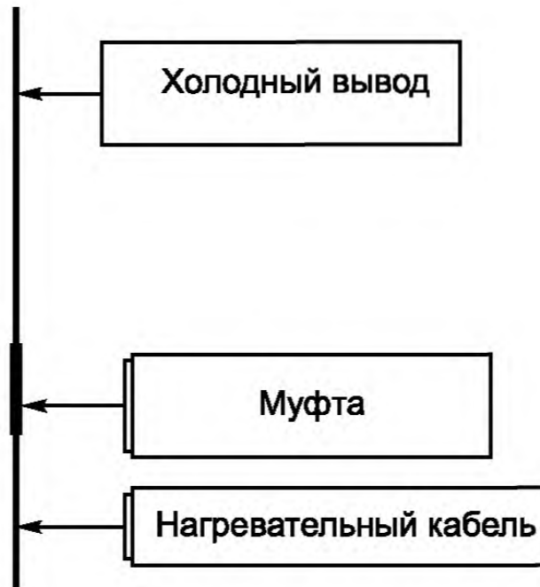
Рисунок 1 - Типовое расположение элементов при испытании муфты
